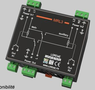
Le module de redondance permet de fournir une protection efficace contre les défaillances d'alimentations AC. Grâce au découplage de deux alimentations, la défaillance de l'une d'elle reste sans impact sur la sortie, l'autre prenant automatiquement sa fonction sans interruption de service.
